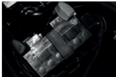
12 v 8,6 Ah sin mantenimiento (MF).
