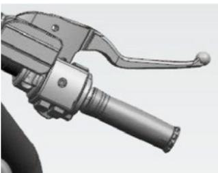
**Maneta del freno delantero:** La maneta del freno delantero se encuentra en el lado derecho del manillar. Cuando necesite frenar, actúe sobre ésta maneta.
