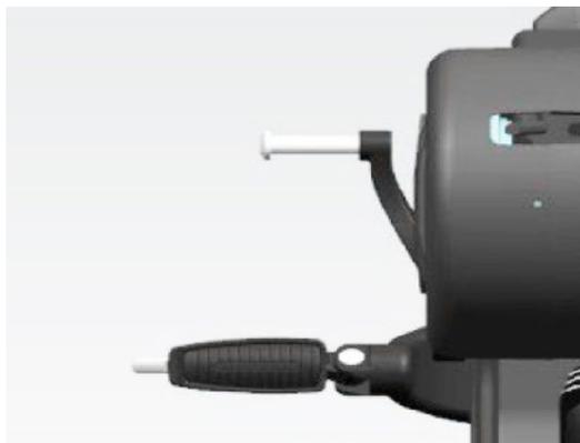
**Palanca de cambio:** El vehículo está equipado con una transmisión de seis velocidades, y cuando usted actúa sobre la palanca de cambios hacia arriba y hacia abajo para cambiar de marcha, la palanca vuelve a su posición original por sí sola.
